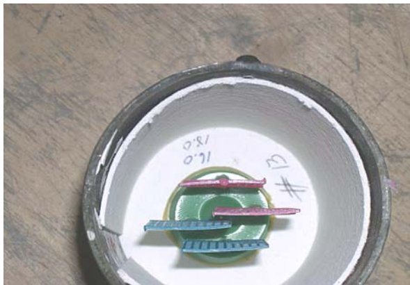
图 4. 模套子装配时所示珠的对齐
